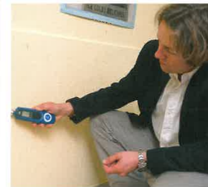
Vor und nach der Sanierung überprüften die Fachleute die Feuchtigkeitswerte.
